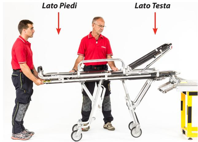
Figura 16 - Posizione degli operatori per il caricamento della barella
