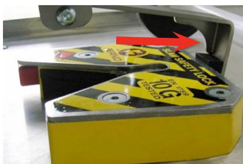
**Figura 8: Sistema anticaduta attivato.**
