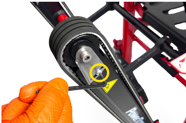
Abbildung 51 - Einstellung der Raupenspannung.
