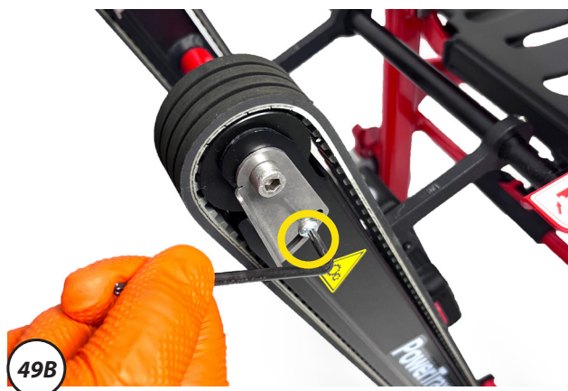
Abbildung 49 - Verfahren zum Lösen des Raupenspanners
