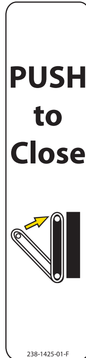
Etikett mit Anweisungen zum Einklappen des Raupenfahrwerks
