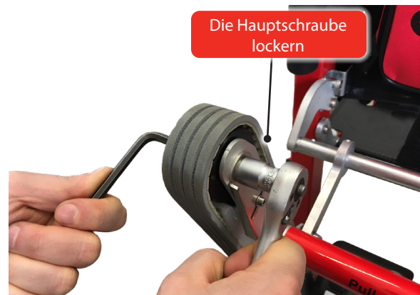
Abbildung 4 - Die Hauptschraube lockern
