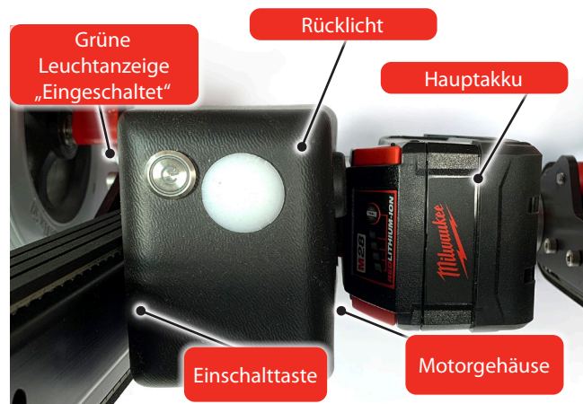
Das System der Vorder- und Rücklichter
