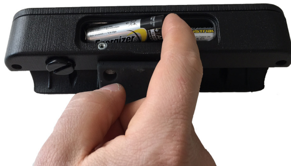
Abbildung 3 - Austausch der Batterien
