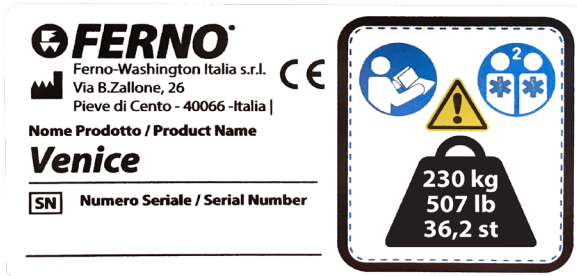
Etikett mit Angabe der Seriennummer und Tragfähigkeit
