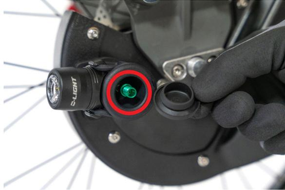
Um den Adapter zu entfernen, die runde Gummikappe vom Lichthalter entfernen, dann den darin befindlichen Adapter lösen.
