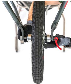
4. Schrauben Sie den Bolzen fest und schließen Sie den roten Arretierhebel.
