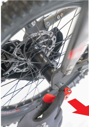
3. Lösen Sie die V-förmigen Radhalterungen durch Drücken des roten Knopfes am Schnelllösesystem.
