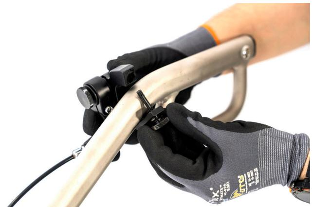
**MERKE:** Sie können entscheiden, ob Sie den Bremshebel innen oder außen am Griffs montieren möchten. Je nach gewählter Position kann der Bremshebel über den entsprechenden Einstellknopf verstellt werden, indem er gelöst, auf die gewünschte Seite verschoben und wieder festgeschraubt wird.
