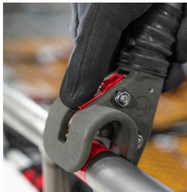
4. Lösen Sie den Bowdenzug vom Rahmen, indem Sie die Klammern lösen.
