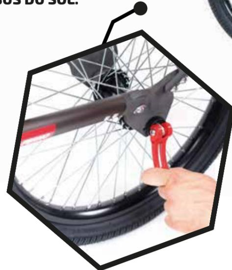
Light Mule : système mono roue composé d'un support de roue pliable en V et d'un blocage fast clip.
