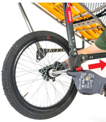
3. Désengager les supports de roue en forme de V en appuyant sur le bouton rouge du système de décrochage rapide.
