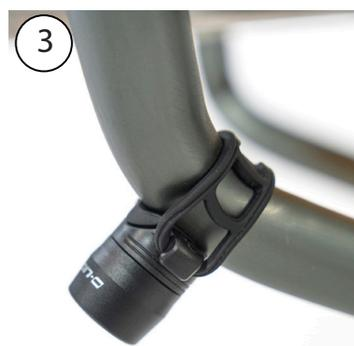
Une fois fixé dans la position souhaitée à l'aide de la petite sangle élastique, il suffit d'appuyer deux fois sur la LED pour l'allumer. En fonction du nombre de pressions exercées, l'ordre sera le suivant :
