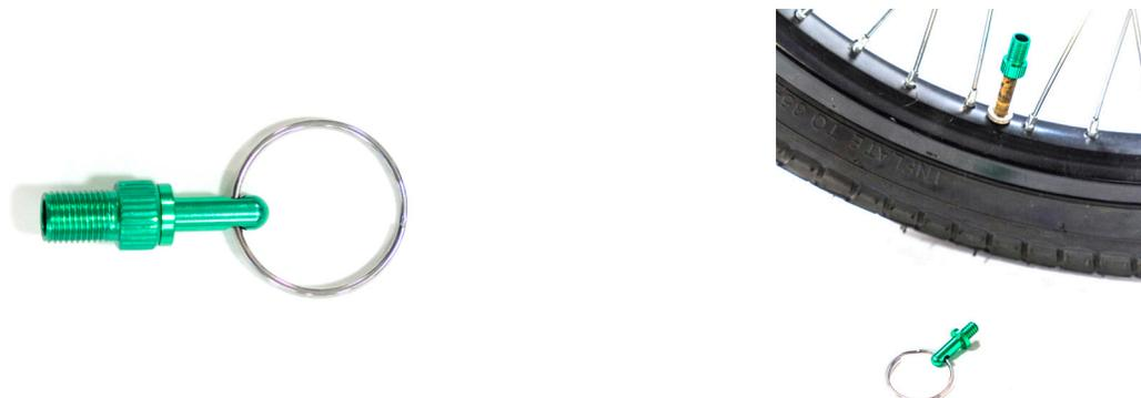
L'adaptateur est relié à un anneau semblable à un porte-clés. Pour l'utiliser, il faut dévisser l'extrémité qui y est reliée. Pour gonfler la roue, dévisser le capuchon de la valve et visser sur celle-ci l'adaptateur avant d'utiliser la pompe de gonflage choisie. Pour retirer l'adaptateur, le dévisser de la valve, revisser le capuchon et l'anneau sur l'adaptateur.
