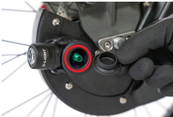
Pour retirer l'adaptateur, retirer le capuchon rond en caoutchouc du support de lumière et dévisser l'adaptateur à l'intérieur.
