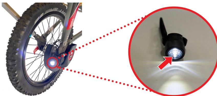
Lorsque la lumière est à plat, elle peut être facilement rechargée en dévissant la partie supérieure contenant la LED et en connectant le câble fourni à la prise micro USB prévue à cet effet.
