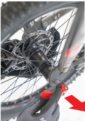
3. Désengager les supports de roue en forme de V en appuyant sur le bouton rouge du système de décrochage rapide.
