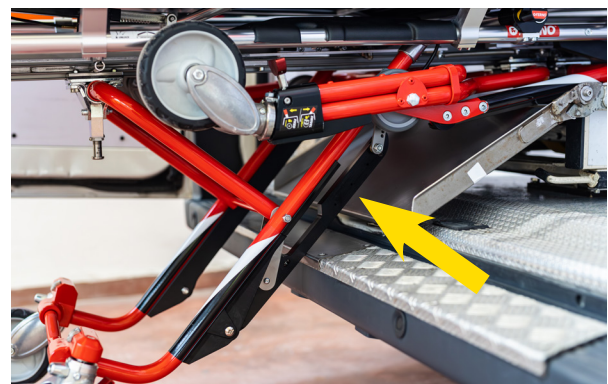
Figure 5 - Système de déblocage mécanique jambes arrière
