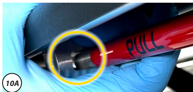
Figura 10 - Azionamento leva telaio piedi
