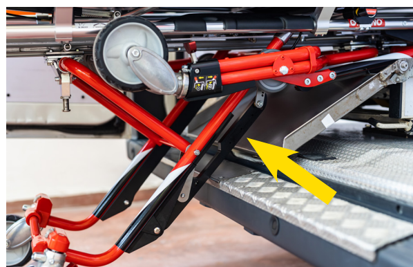
Figura 5 - Sistema di sblocco meccanico gambe posteriori
