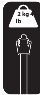
Etichetta limite di portata asta per flebo (sull'asta). L'etichetta specifica il carico massimo dell'asta.
