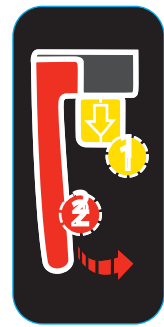
Etichetta sblocco montante laterale (vicino alla maniglia). Mostra l'uso della maniglia.
