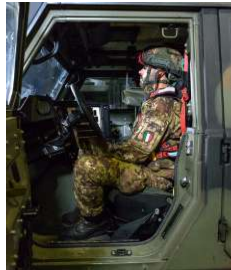
Figure 88 - Personne blessée fixée à l'XT MILITARY après le serrage de toutes les sangles
