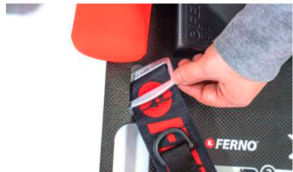
Figure 113 - Mise en place de la boucle métallique du floqueur de poitrine
